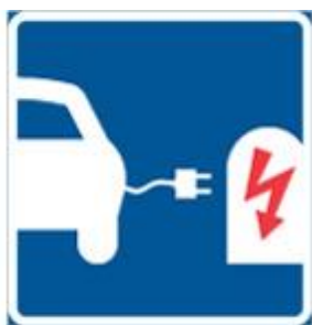
Figur 5-2 Tilläggstavla T24 Laddplats. Tavlan anger en plats för extern laddning av elektricitet för fordons framdrivning. Tavlan används under märke E19, parkering, och anger att endast fordon med möjlighet till extern laddning av elektricitet för fordonets framdrivning får parkera.
