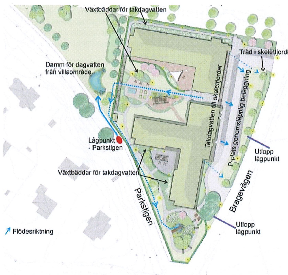
Systemskiss för dagvattenhantering inom planområdet.
