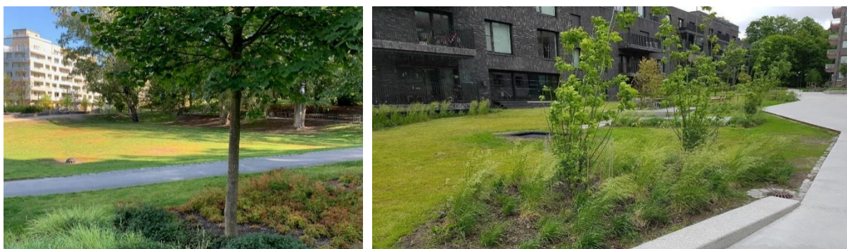
Figur 23. Infiltration i grönyta bidrar till rening, fördröjning och infiltration till grundvatten men är en ytkrävande åtgärd. Exempelbilder från Stockholm och Göteborg. (Foto: Bjerking).
