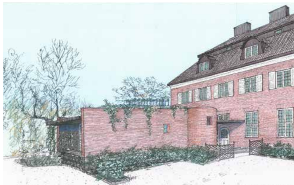
Fasadskiss från gårdsmiljön över föreslagen tillbyggnad vid huvudbyggnadens nordöstra sida. Gaturummets murinspirerade tegelfasad återkommer, men är uppbruten med en svagt rundad del för trappa till takaltan. Det centralt placerade fönstret ger ljus till bageriet. Befintligt räcke vid köksingången är framflyttat för att skapa en tydlig gästenré. Lastbrygga och personalingång är diskret inordnade i den indragna gaveldelen. Den för miljön återkommande kopparplåten används i takutsprången över lastkaj och gästenré.
