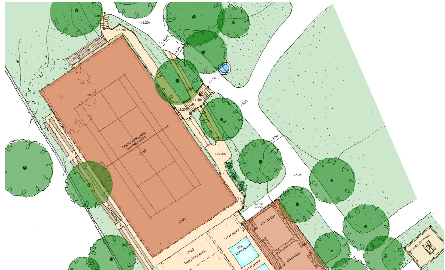
Planskiss över föreslagen omgestaltning av området kring tennisbanan med ny stig/ramp som tillgängliggör den något högre belägna tennisplanen.
