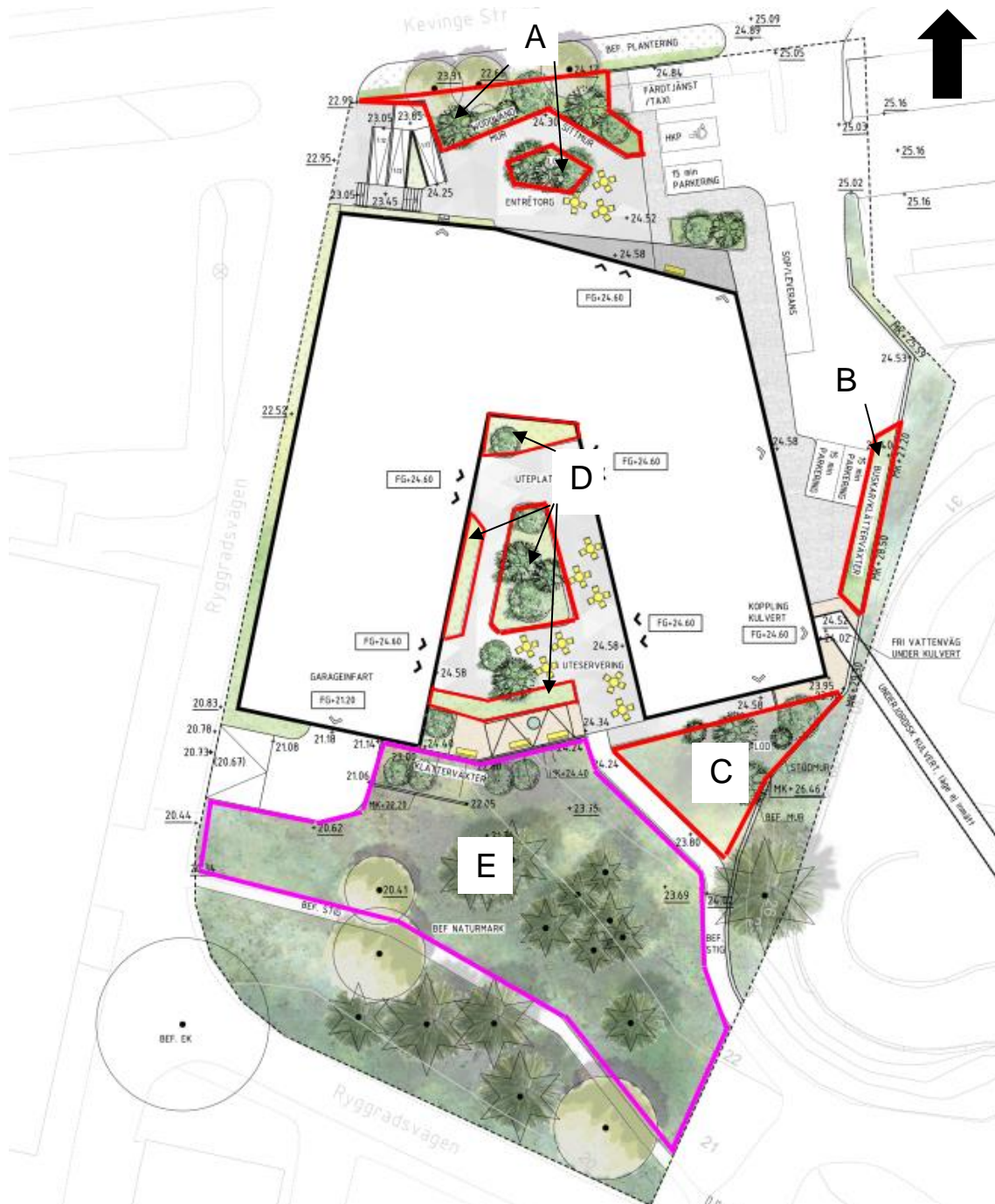
Figur 11. Placering av planerade och föreslagna LOD-åtgärder. Röd markering innebär växtbädd/infiltrationsyta och lila markering innebär yta där magasin ska placeras.
