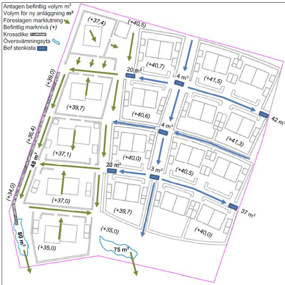
Föreslagen dagvattenhantering inom planområdet samt rekommenderade marklutningar (pilar).
