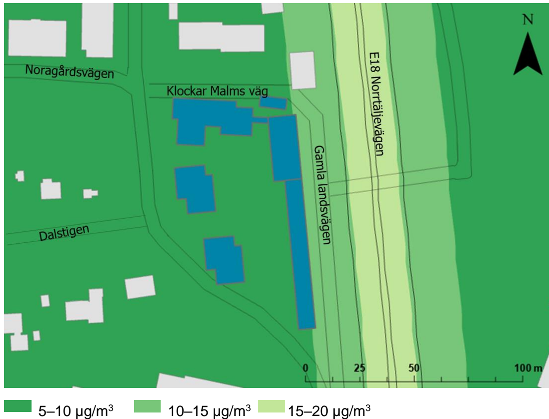
Figur 10. Beräknad årsmedelhalt av kvävedioxid, NO 2 (µg/m 3 ) i utbyggnadsalternativet år 2030. Halterna gäller 2 m ovan gatunivån för ett normalt meteorologiskt år. Den planerade bebyggelsen visas som blå polygoner.
