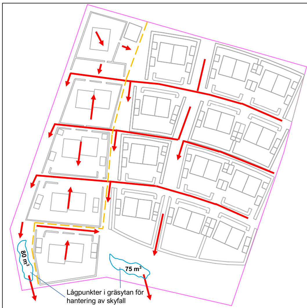
Figur 13. Dagvattenhantering vid skyfall, sekundära avrinningsvägar, Scalgo
