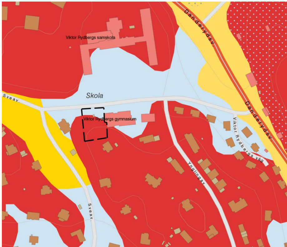
Figur 3. Översiktlig jordartskarta över planområdet (svartmarkerat). Rött – berg, ljusblå – sandig morän, gul – glacial lera, rött med ljusblå prickar – urberg med tunt eller osammanhängande ytlager av morän (Jordartskarta, SGU).
