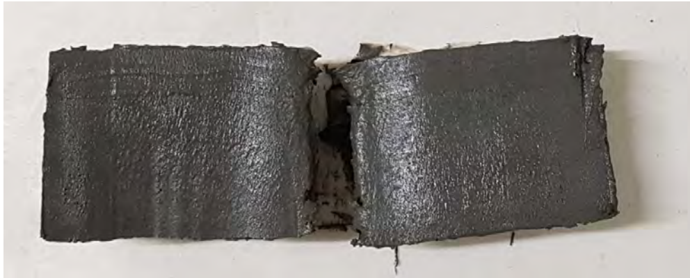
Figur 2 Borrpunkten, BG19008, 6 m, Jordprovet i övre delen av mellanhylsan delad longitudinellt provhysan med id SWECO 946.
