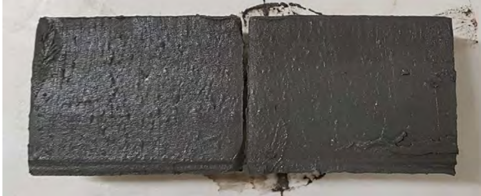
Figur 1 Borrpunkten, BG19008, 3 m, Jordprovet i övre delen av mellanhylsan delad longitudinellt provhysan med id MRM 0668.
