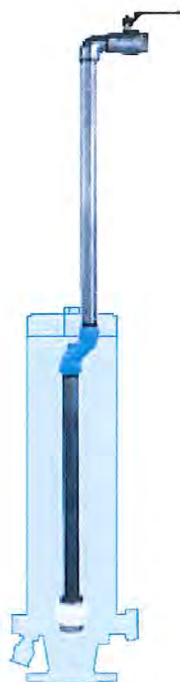
Figur 11. Exempel spolrör för installation i avluftningsenhet. (Källa: Belos)
