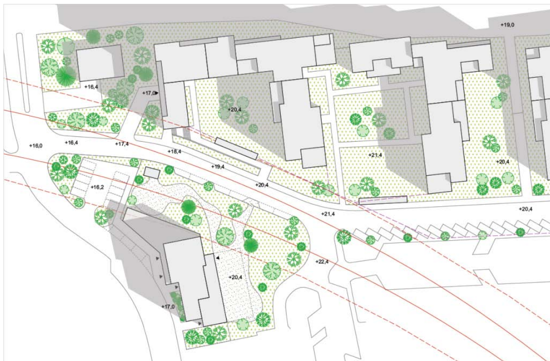
Bild 1. Norra delen av planområdet. Tunnelbanan och dess skyddszon är markerade med röda linjer. Utdrag från utredningsskiss UA178, Ettelva Arkitekter. Norr är riktat åt vänster i figuren.
