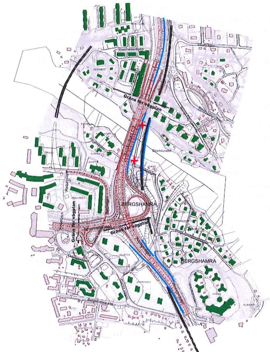
Figur 12. Bullerberäkning för spont i två punkter. Spontningspunkter är markerade med röda kryss. Ekvivalenta ljudnivåer överskrider riktvärden vid fasad för byggnader som är grönmålade.
