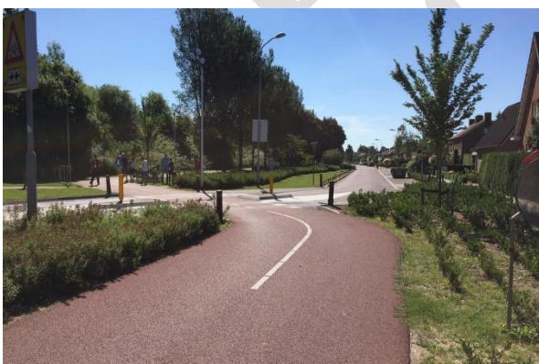
Figur 10. Typlösning för gång- och cykelpassage vid sidbyte som är anpassat för att förbättra cykeltrafikens framkomlighet med vinklade passager. För ökad trafiksäkerhet kan även bilvägen vinklas till 45 grader vid passagen så att cykelpassagen korsar vägen i vinkelrätt.
