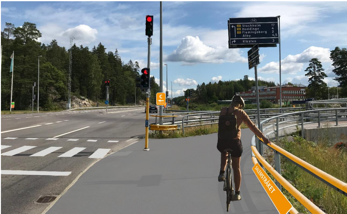
Figur 16. Ett sätt att använda signaturfärg för att tydliggöra de regionala cykelstråkens sträckning i korsningspunkter. Signaturfärgen återkommer på båda sidor i korsningen där det regionala cykelstråket fortsätter.
