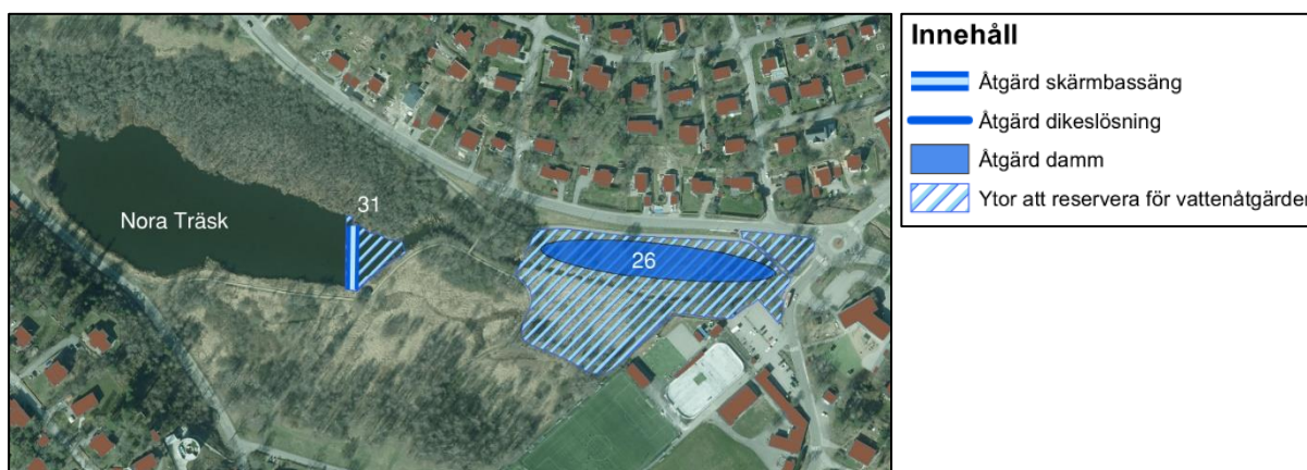
Figur 3. Lokalisering av föreslagna prioriterade åtgärder nr. 26 (fördamm/utvidgning) och 31 (skärmbassäng). Åtgärderna föreslås anläggas vid Nora träsk's inlopp, inom Edsvikens avrinningsområde (Ortofoto från © Lantmäteriet).
