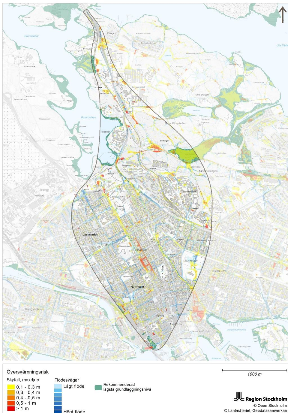
Figur 15. Maximala vattendjup och flöden vid ett 100-årsregn (Källa: Stockholms stads skyfallskartering) samt Länsstyrelsens rekommenderade lägsta grundläggningsnivå (+ 2,7 m i RH2000).
