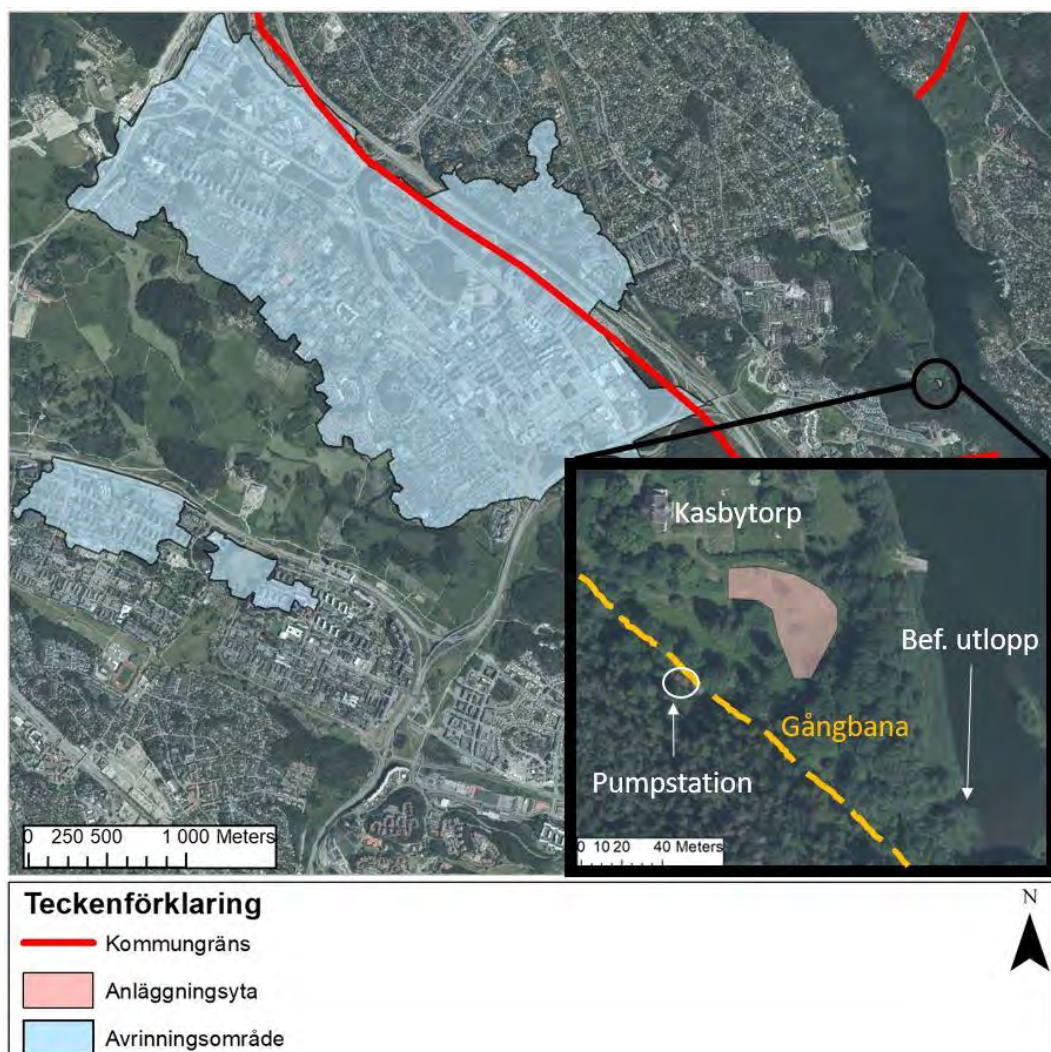
Figur 2 – Avrinningsområde i Stockholm till föreslagna anläggning i Sollentuna. I inzoomad bild visas föreslagna anläggningsyta, område för nuvarande pumpstation och befintligt utlopp samt gångbana. Avrinningsområde norr om kommungräns avser det avrinningsområde i Sollentuna som avleds till Järva dagvattentunnel.
