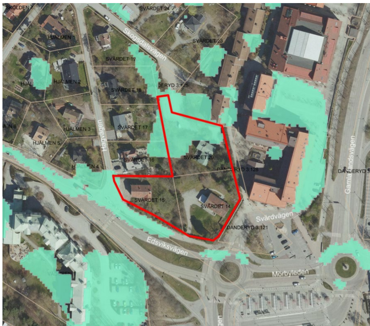
Bild 17. Skyfallskartering vid 100-årsregn.
