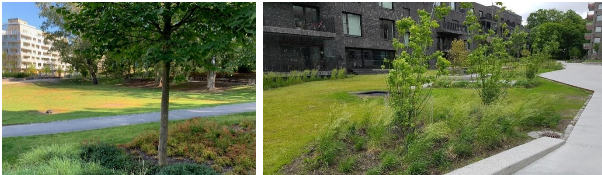
Figur 23. Infiltration i grönyta bidrar till rening, fördröjning och infiltration till grundvattnen men är en ytkrävande åtgärd. Exempelbilder från Stockholm och Göteborg. (Foto: Bjerking).
