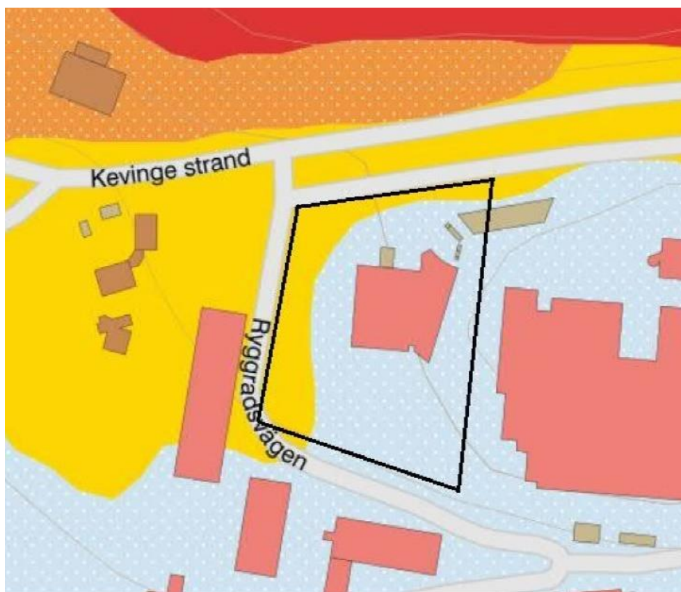
Utsnitt ur SGU:s jordartskarta från PM Geoteknik Sjukhuset 7, Tyréns 2020-10-13, med ungefärligt utredningsområde markerat. Ljusblå prickig yta visar sandig morän och gul färg visar glacial lera.
