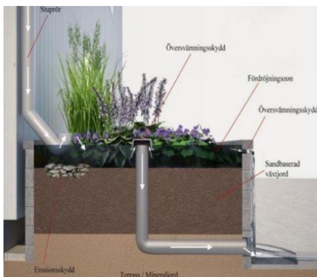
Figur 5. Principskiss över växtbäddskonstruktion med stuprörsanslutning och bräddavlopp.
