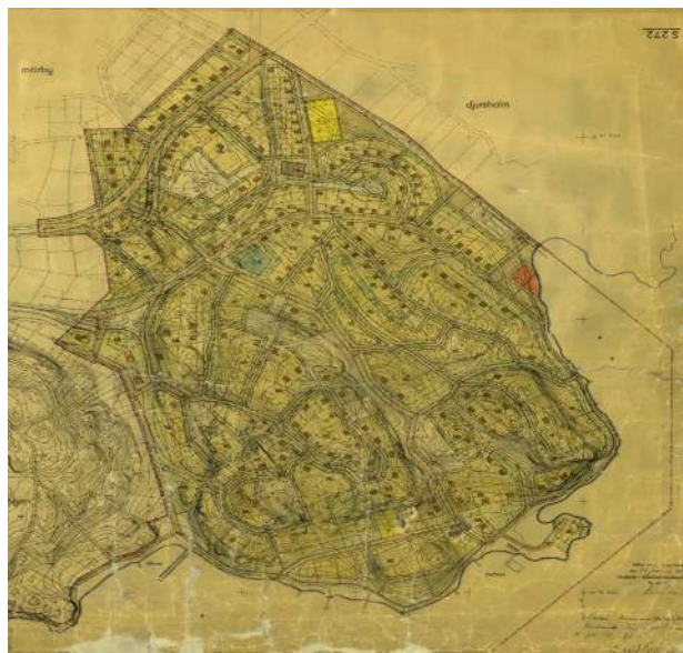
Förslag till stadsplan för Långägen Stocksunds köping i Stockholms län. Upprättad 1935, fastställd 1940-01-26. Befintliga byggnader är markerade med svart linje och är svåra att urskilja på denna bild. Planlagda, ej uppförda byggnader, är markerade i brun kulör.
