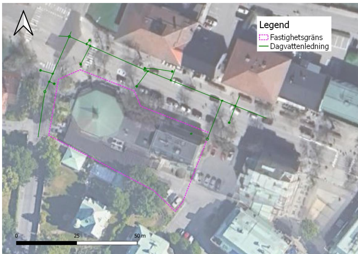
Figur 3-9. Lokalt dagvattennät och brunnar kring fastighetens närhet. Data erhållet från beställaren: 2024-06-19.
