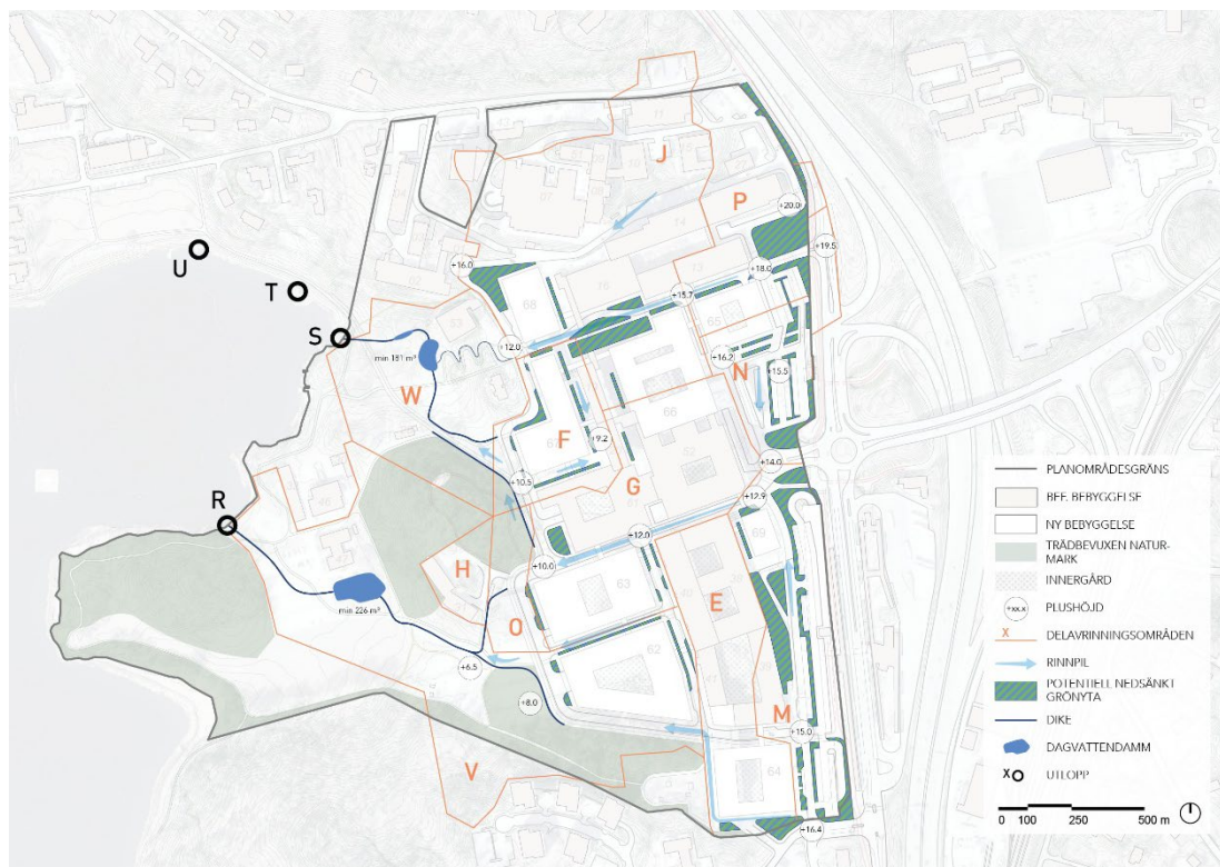
Figur 9. Översikt över föreslagen dagvattenhantering inom planområdet. Pilar visar generell avrinningsriktning.
