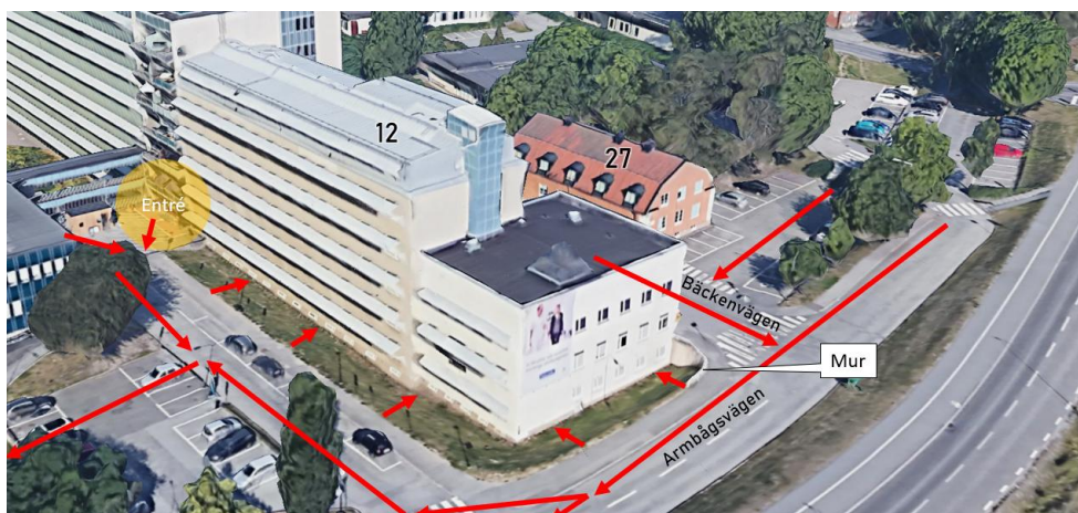
Figur 9. Avrinningsvägar vid byggnad 12. De röda pilarna närmast fasad vid Armbågsvägen visar flödesvägarna från modellen där muren inte tas i beaktning. Vattnet från Armbågsvägen förväntas i huvudsak rinna vidare mot parkeringen. Källa: Google Earth .
