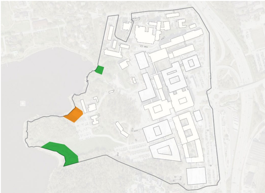
Figur 19: Geotekniska förutsättningar längs strandlinjen vid Edsviken. Lerområden med krav på förstärkningsåtgärder redovisas som begränsningsområde typ 1 (grönt) och typ 2 (orange).
