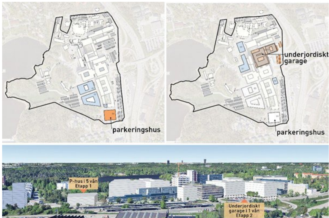
Figur 50. Scenario 3 "bibehållet parkeringstal". Till vänster visas etapp 1 och till höger etapp 2. Blå markeringar visar nya tillkommande byggnadsvolymer, medan orange markeringar visar tillkommande parkeringsanläggningar i respektive etapp.
