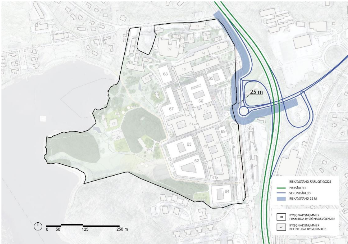
Figur 15. Visualisering av individrisk på Mörbygårdsvägen, där blått område representerar ALARP-zonen. (illustration av &Rundquist)
