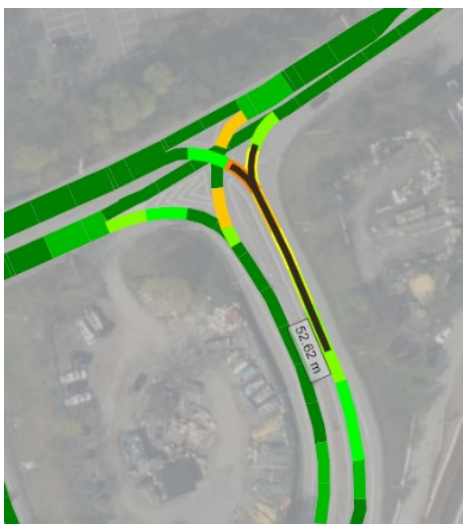
Figur 44 Avfartsrampen i trafikplats Danderyds sjukhus under eftermiddagens maxtimme.
