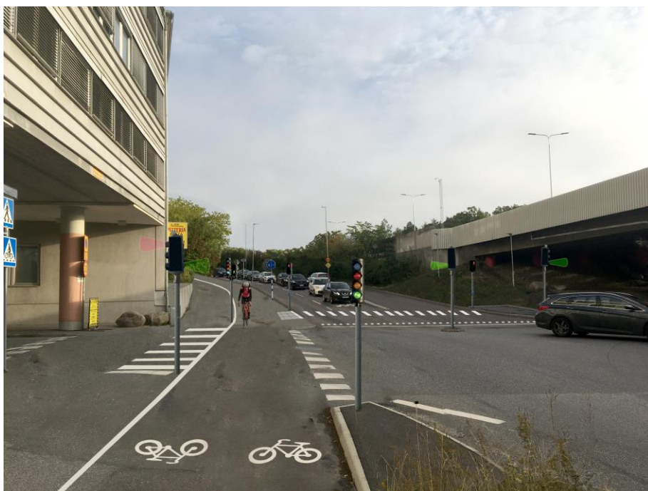
Figur 39 Skiss visande ungefärligt utseende med breddad gång- och cykelbana, flyttat övergångsställe över Mörbygårdsvägen samt signalreglering av hela korsningen
