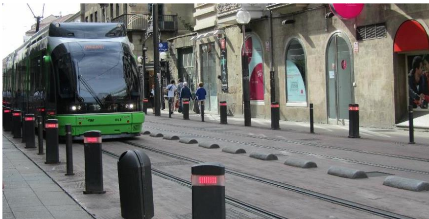
Figur 38 Exempel på pollare som tänds för att varna för annalkande spårvagn
