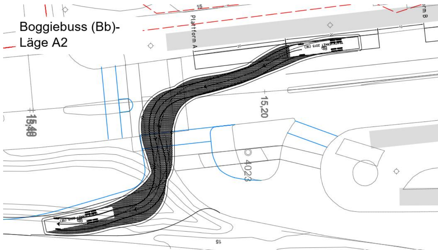
Figur 14 Körspår för boggiebuss från hållplatsläge A. Mörkgrå skraffering visar den yta som bussen tar i anspråk. (Norr åt höger i bilden).
