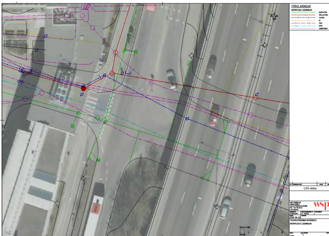
Figur 32 Befintliga ledningar i korsningen
