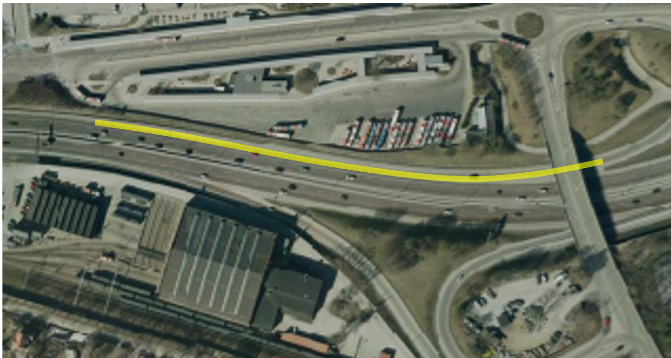
Figur 4 Rampnosen, markerat med gult, på påfartsrampen i trafikplats Danderyds sjukhus är cirka 330 meter till utspetsningens slut. (Norr åt höger i bilden).
