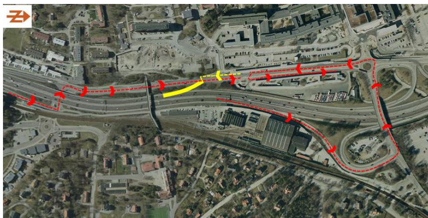
Figur 51 Situation med utfart från bussterminal. Ett möjligt ungefärligt läge för påfart visas med gul heldragen linje. Bussar som trafikerar mot Stockholm är markerat med gul streckad linje, och röda streckade linjer visar två möjliga vägar för bussar från Stockholm mot bussterminalen.
