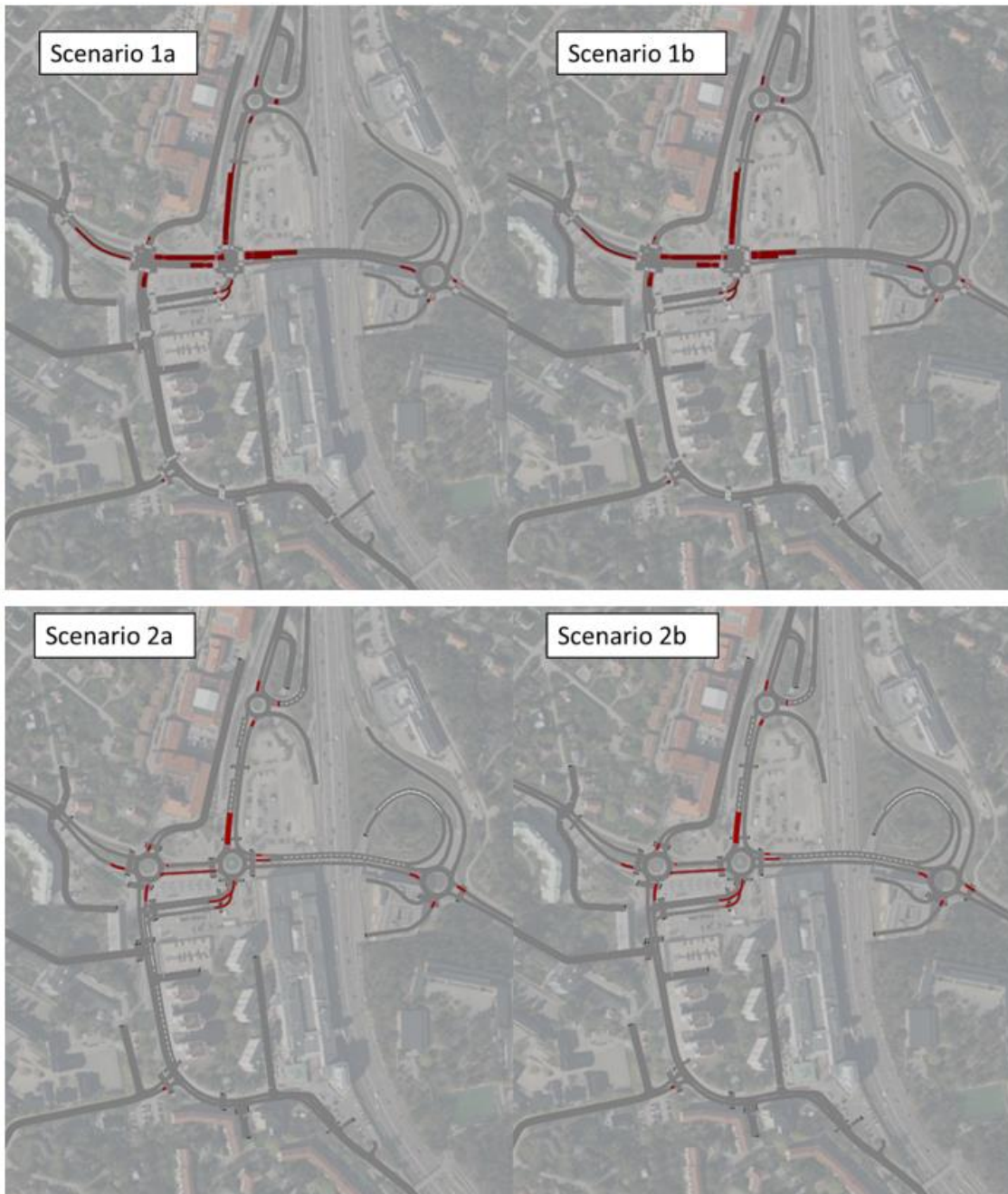
Figur 33- Kölängder FM alla scenarier. 1a (två signalreglerade korsningar med kollektivtrafikkörfält), 1b (två signalreglerade korsningar utan kollektivtrafikkörfält), 2a (två cirkulationsplatser med kollektivtrafikkörfält), 2b (två cirkulationsplatser utan kollektivtrafikkörfält)
