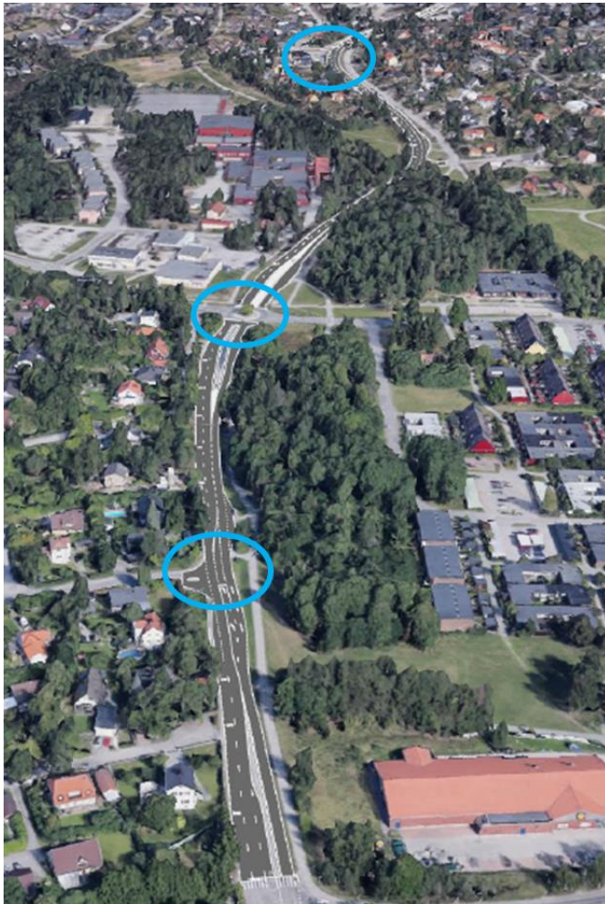
Figur 3-12 Förslag enligt tidigare utredning med busskörfältets avbrott markerade i blått av Trivector. Foto och körfältsillustration: WSP
